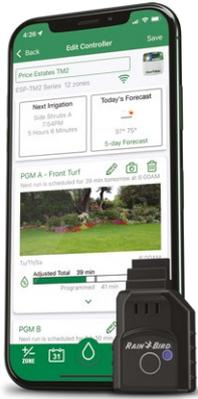
Mit dem LNK-WLAN-Modul und der KOSTENLOSEN mobilen Rain Bird-App erhalten Sie über ihr iOS (ab V8)- oder Android (ab V6)-kompatibles Smartphone oder Tablet Zugriff auf das Steuergerät sowie Tools für externes Management, Echtzeitwarnungen und erweitertes Wassermanagement.
